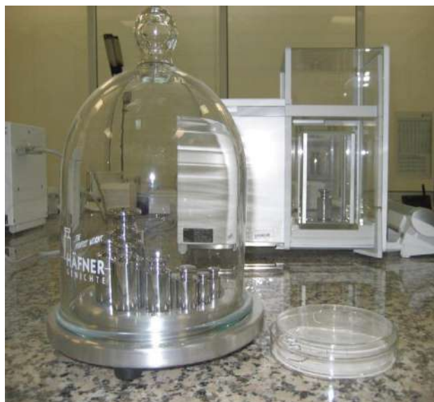
2 – Сурет – Сыну көрсеткіші бірлігінің мемлекеттік эталоны
