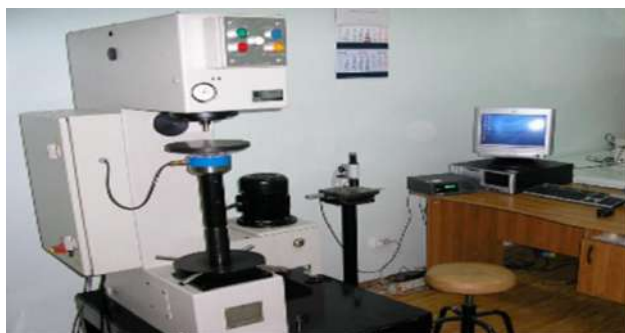
6– Сурет – Виккерс шкаласы бойынша қаттылықтың мемлекеттік эталоны
