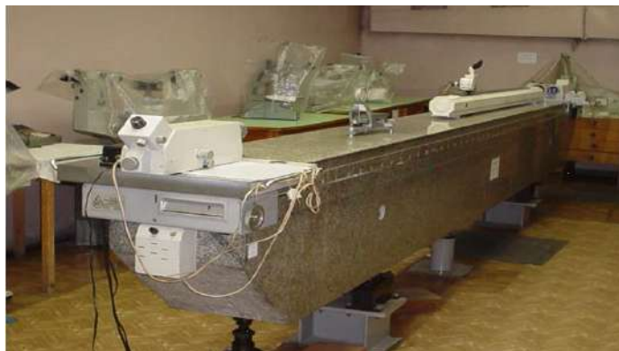
4 – Сурет – 100ден 1000 мм ауқымдағы ұзындықты бірлікті мемлекеттік эталон
